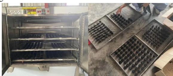
Gambar 2. (a). Briket basah yang dikeringkan dengan tray dryer (b). Hasil briket cetakan yang telah kering
