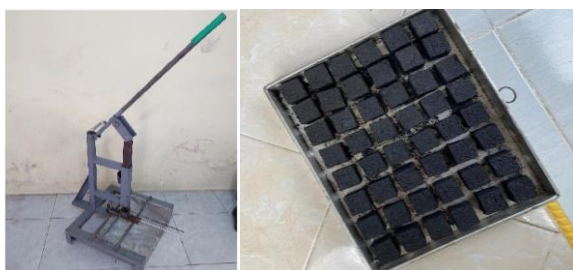
Gambar 1. (a). Alat pencetak briket (b). Briket hasil cetakan
